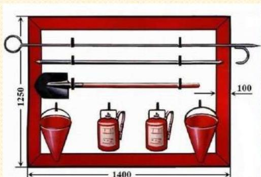
**Пожарный щит** предназначен для размещения первичных средств пожаротушения, немеханизированного инструмента и пожарного инвентаря.
