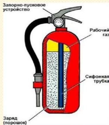
Предназначен для тушения пожаров и загораний нефтепродуктов, ЛВЖ и ГЖ, растворителей, твердых веществ, а также электроустановок под напряжением до 1000 В.
