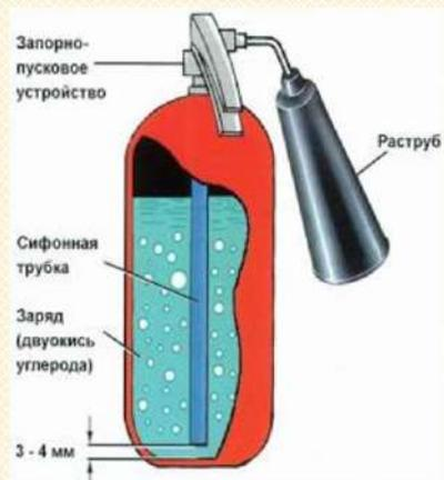
Предназначен для тушения загораний различных веществ и материалов, а также электроустановок, кабелей и проводов, находящихся под напряжением до 1000 В, двигателей внутреннего сгорания, горючих жидкостей.
